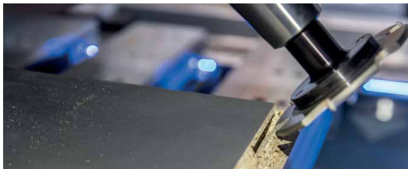
Fraisage de rainure profilée P-System avec la Homag Venture 316 L CNC 5 axes
